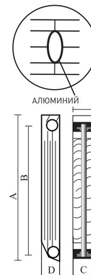
\*Примечание: Тепловой поток указан при нормальных условиях. Тепловой поток (Q) радиаторов при ΔT отличающемся от 70°C, пересчитывается по формуле:  $Q = Q_{\text{дт}70^{\circ}\text{C}} \cdot (\Delta T/70^{\circ}\text{C})^n$ , где n=1,30.
